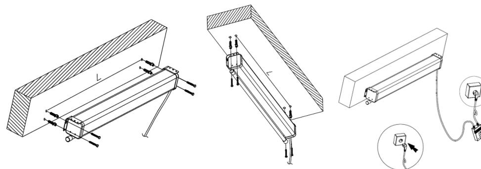
2. При необходимости закрепите переключатель на стене так, чтобы он был доступен при полностью развернутом экране.
